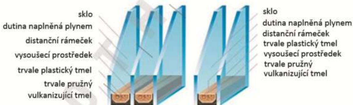
Obr. 1 Schéma izolačního trojskla a dvojskla.
